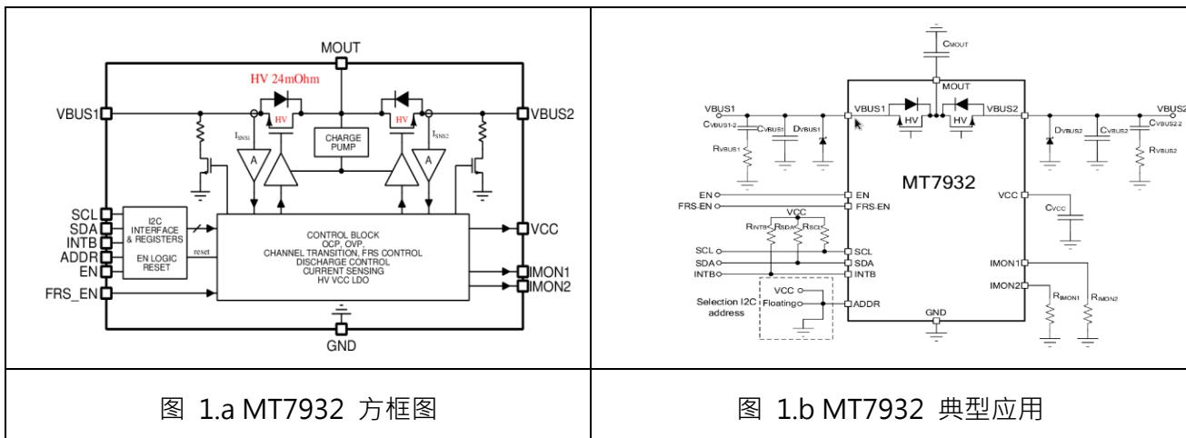
MT7932 具备 33V、5A 的高耐压与大电流能力，集成 25mΩ 超低导通电阻 ( Rdson ) 的功率器件，并支持无损电流检测和模拟电流回报功能。MT7932 提供完整的保护功能，包括：
